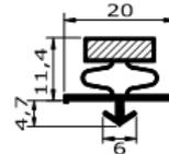
**Magnetdichtungen zur Schraubmontage**
