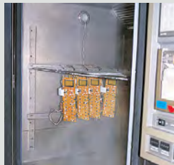
Leiterplatten-Bewertungstest*4 Temperatur von -40 °C bis +85 °C, relative Luftfeuchtigkeit 85 %
