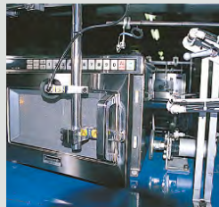
Dauerprüfung der Tür (Öffnen und Schließen)*4 400.000-faches Öffnen und Schließen der Tür
