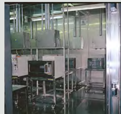
Kombinierter Belastungstest*4 Temperatur von 0 °C bis +40 °C, relative Luftfeuchtigkeit 85 %
