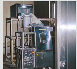
Staub- und Wrasentest*4 Betrieb in Staub und Wrasen bei einer Temperatur von +40 °C und einer relativen Luftfeuchtigkeit von 95 %
