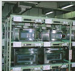
Dauerprüfung bei intermittierendem Betrieb*4 Ein (60 s) und Aus (30 s), 200.000-Mal; Ein (20 s) und Aus (10 s), 200.000-Mal
