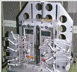
Dauerprüfung des Bedienfelds*4 200.000-fache Betätigung der Tastenfelder
